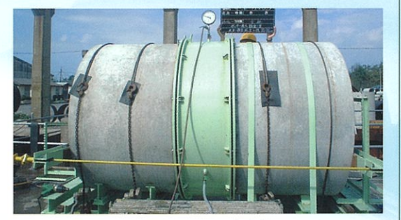
外水圧水密試験装置の全景(呼び径 1350) 鉄筋コンクリート管を直列に並べ、内側にマグマロック、外側に外水圧試験装置を取り付けた試験装置
