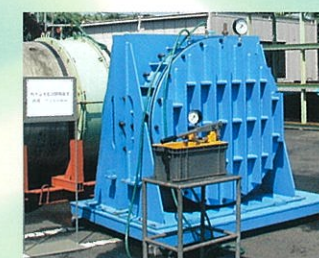
内水圧試験状況
