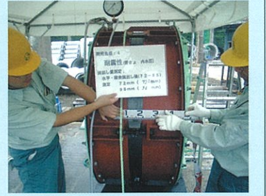
鋼製分割型内水圧水密試験装置 (呼び径 1350)
