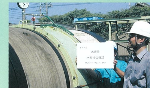
スナップロック工法MLの外水圧試験
