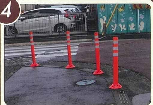
4 巻き込み防止 大回りさせることにより歩行者の保護、内輪差による事故防止に役立ちます。
