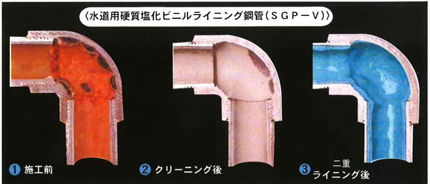
〈水道用亜鉛めっき鋼管(SGP)〉
