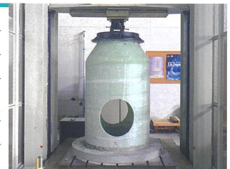
耐荷試験状況
