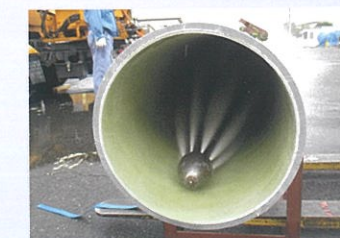
耐高圧洗浄試験
